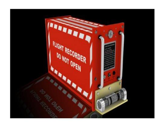
黑匣子是飞机专用的电子记录设备之一,又称为航空飞行记录器。里面装有飞行数据记录器和舱声录音器,飞机各机械部位和电子仪器仪表都装有传感器与之相连。它能把飞机停止工作或失事坠毁前半小时的有关技术参数和驾驶舱内的声音记录下来,需要时把所记录的参数译码出来,供事故分析之用。
